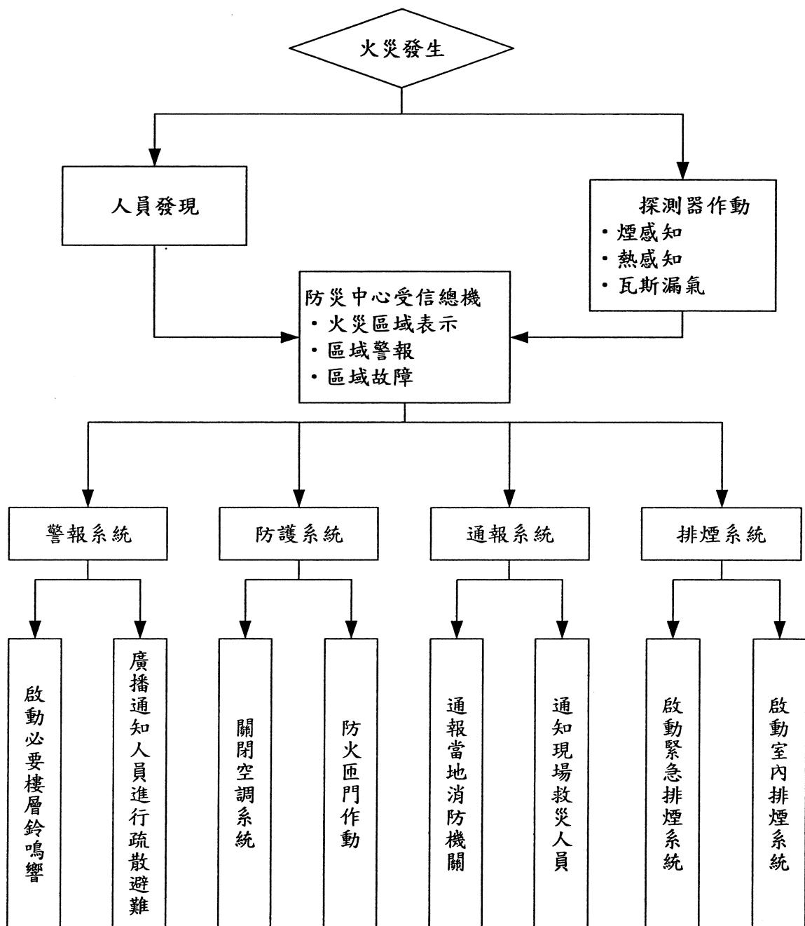
圖 2 消防防災系統流程
