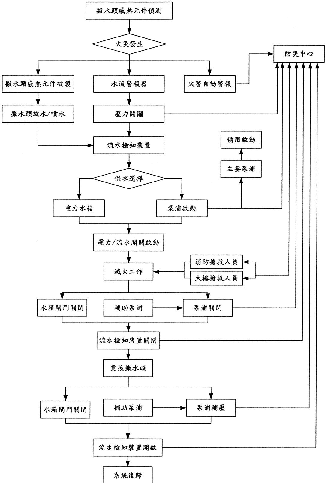
圖 5 自動撒水系統動作流程圖
