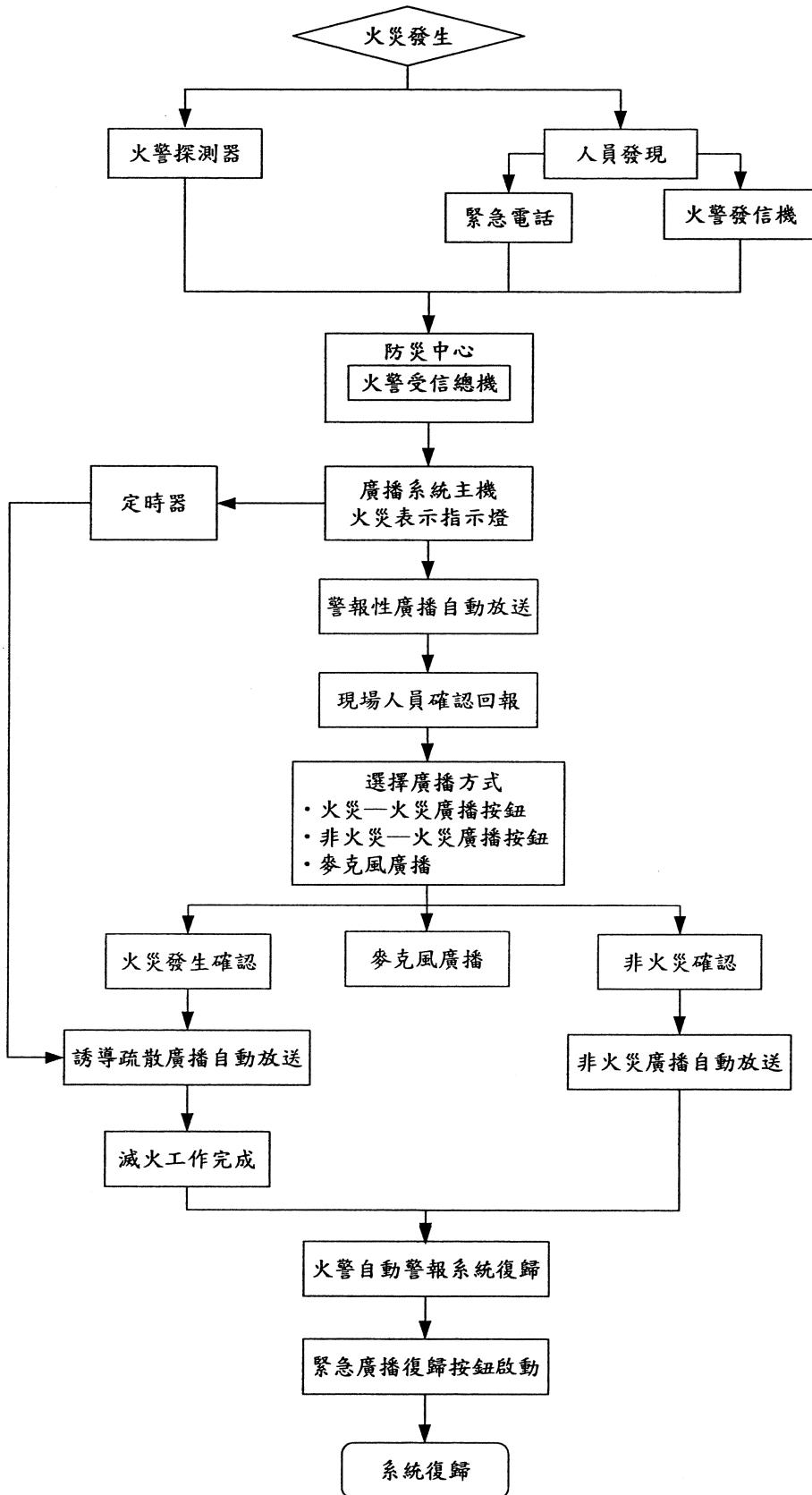
圖 6 緊急廣播系統動作流程圖
