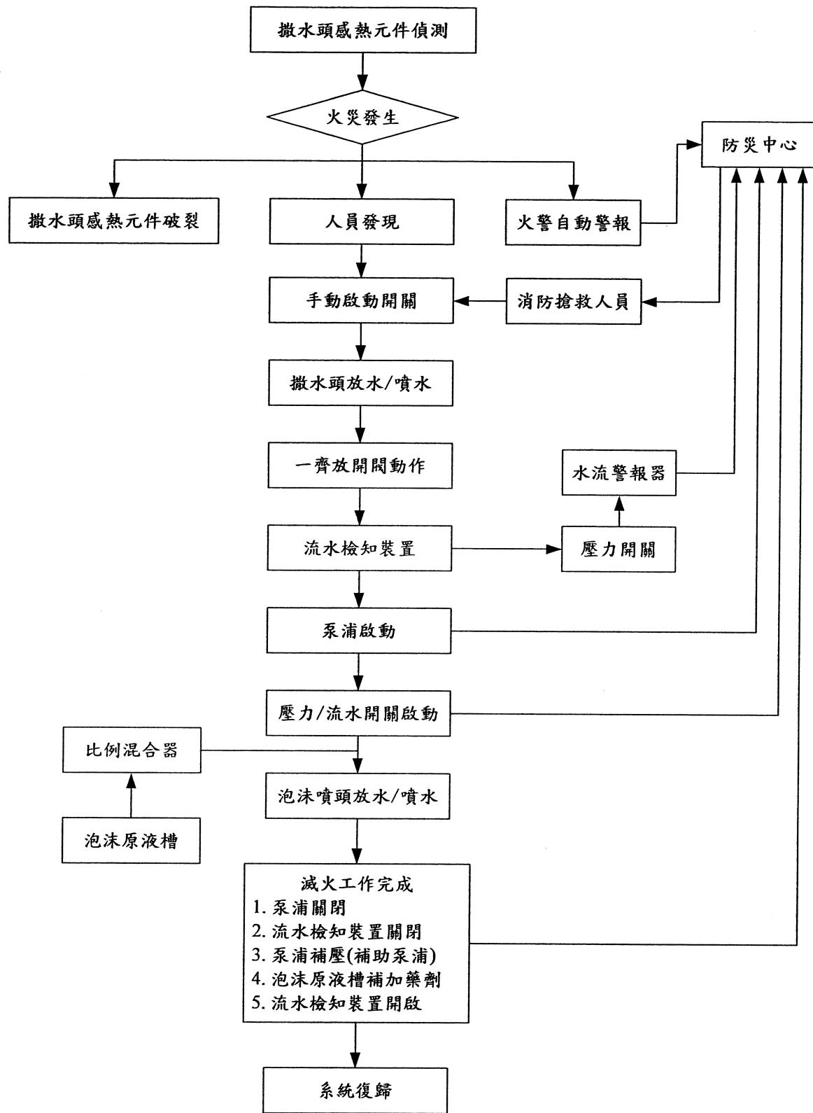
圖 3 泡沫滅火系統動作流程圖
