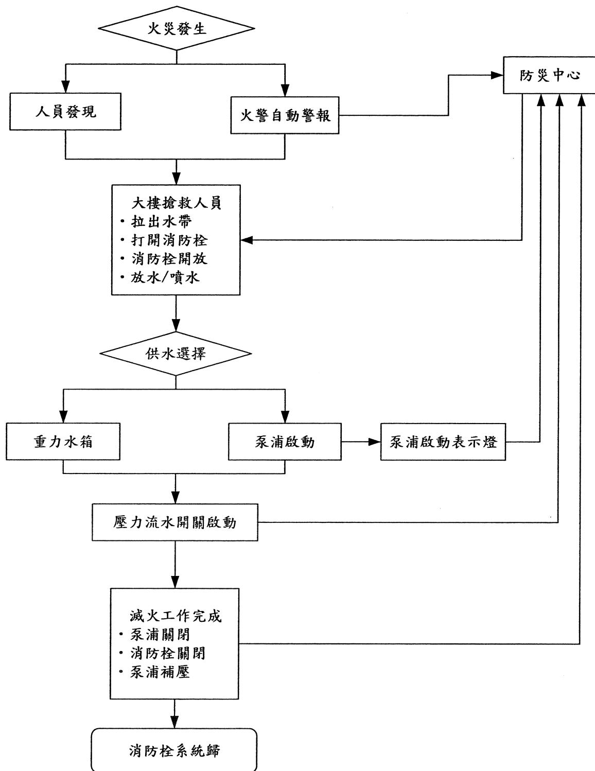
圖 4 消防栓系統動作流程
