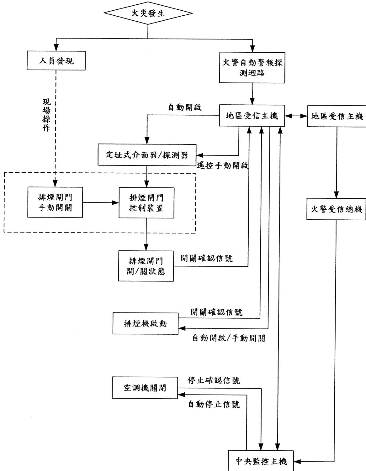
圖 7 排煙設備連動流程圖
