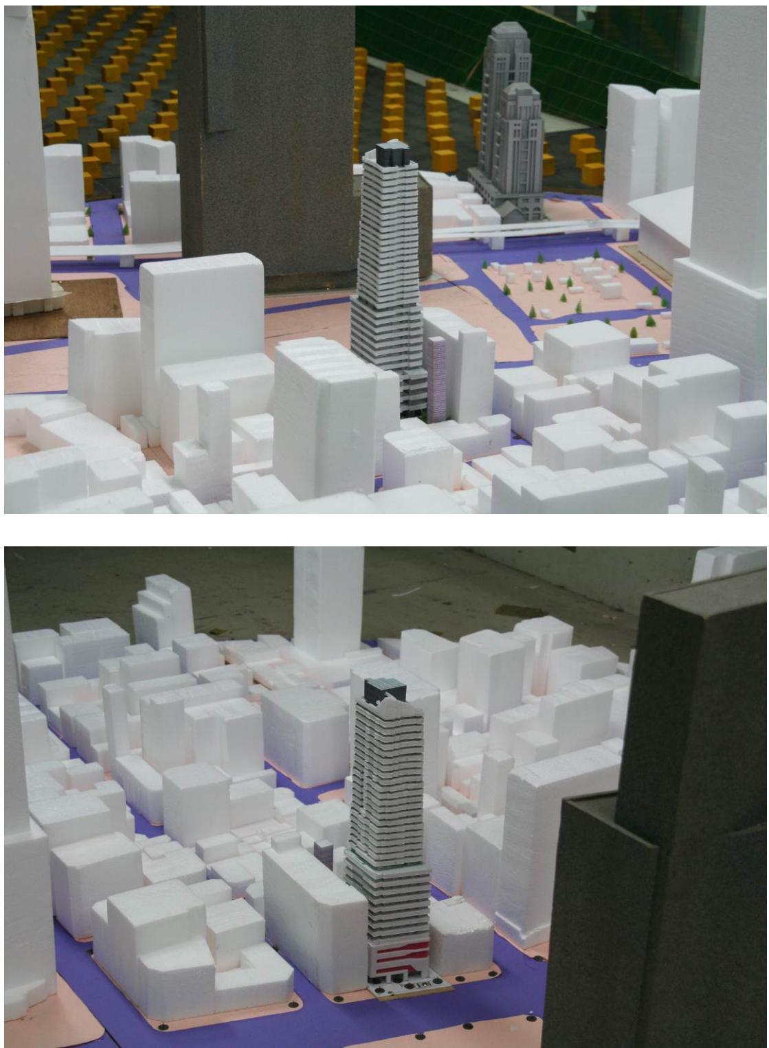
圖 2 風洞試驗主模型與周圍地形佈置情形
