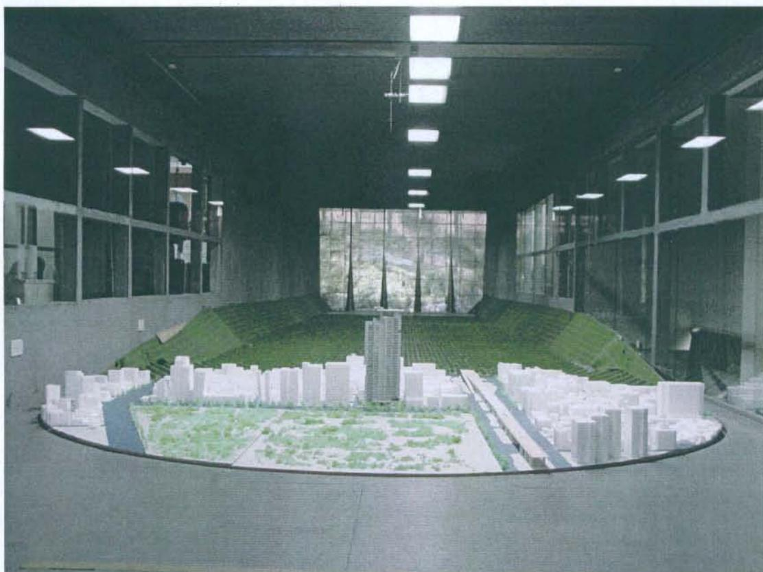
圖 1-3 風洞試驗模擬範圍建物模型（1）（縮尺 1：300）
