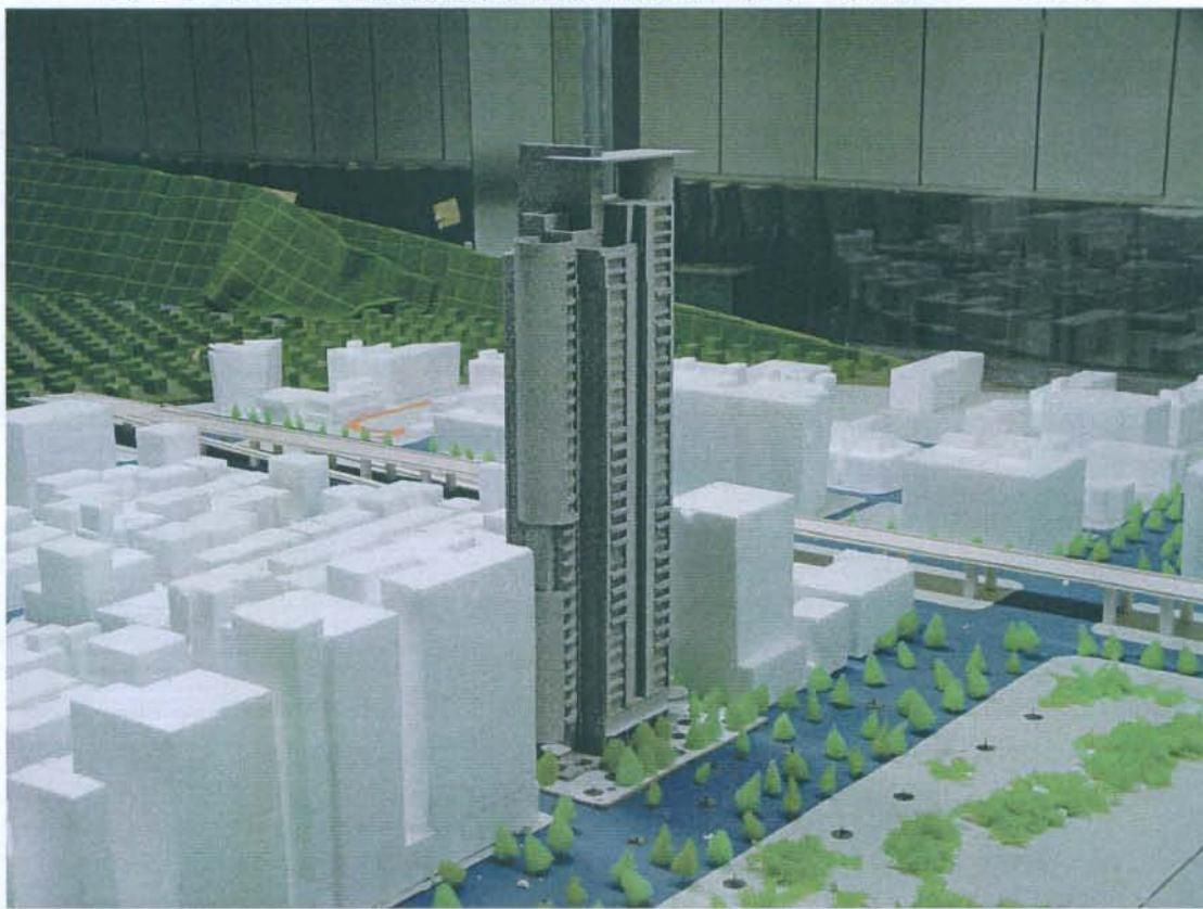
圖 1-6 風洞試驗模擬範圍建物模型（4）（縮尺 1：300）
