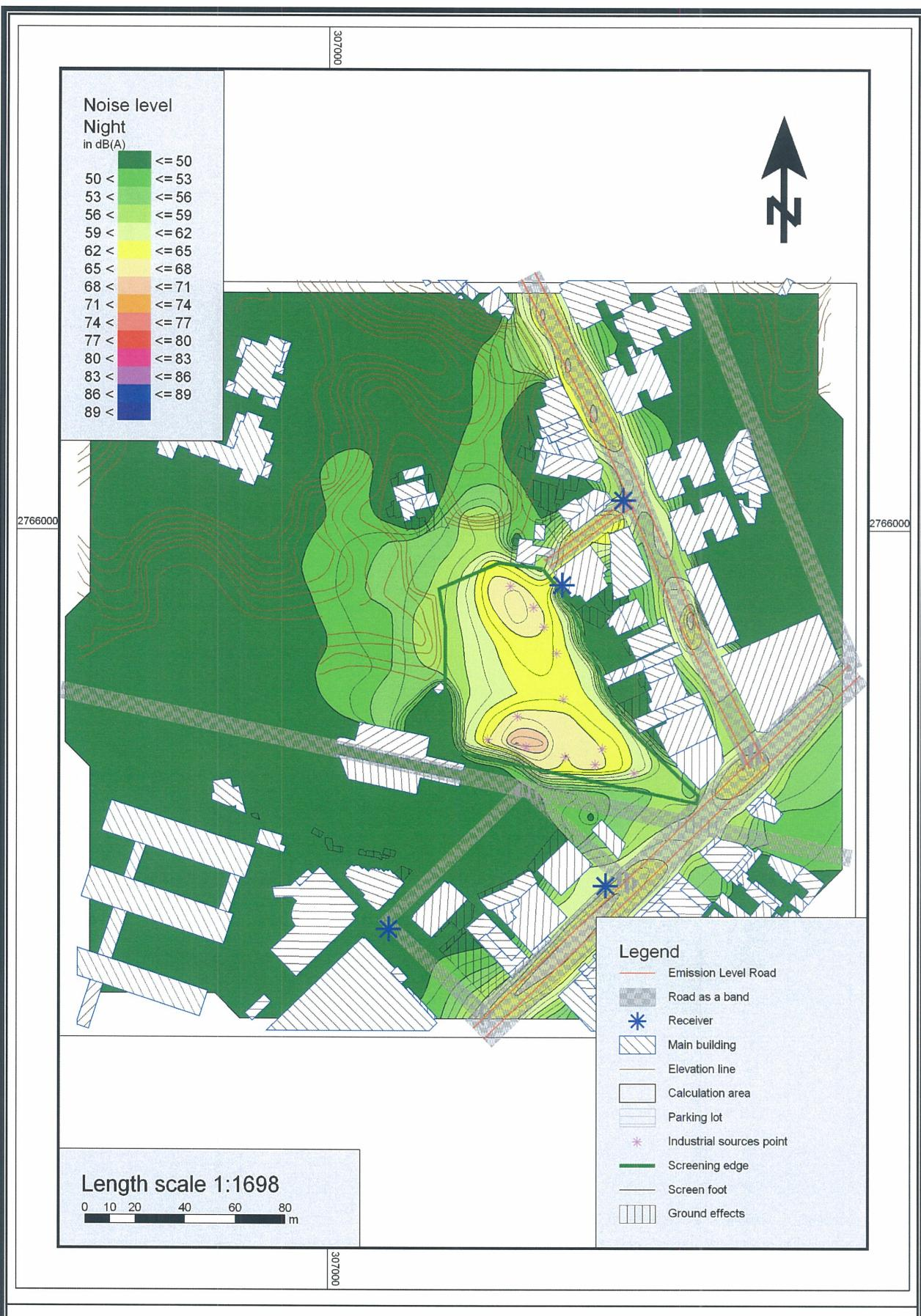
圖3.3-3 施工尖峰期間等噪音線模擬圖( $L_{\text{夜}}$ )
