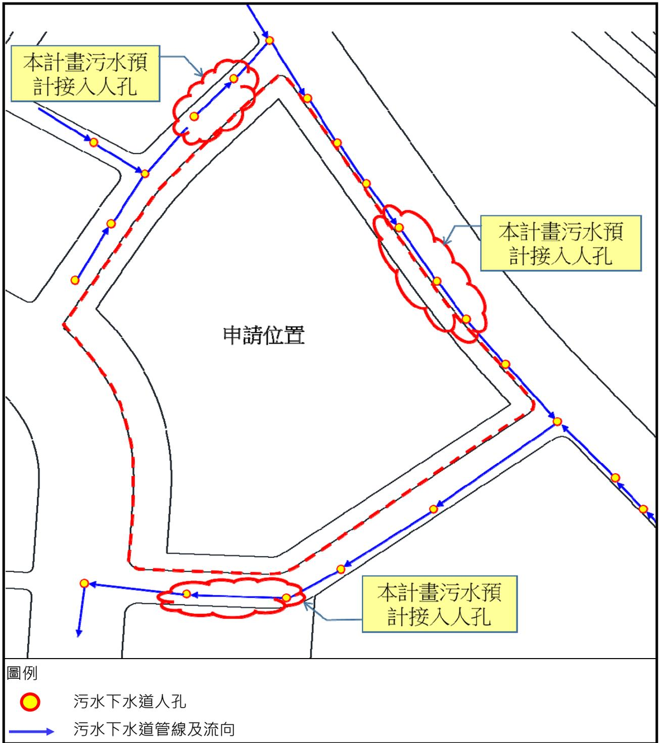
圖7-3 基地周邊污水下水道系統圖
