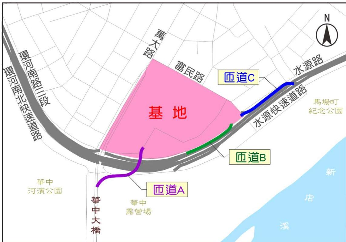
圖 7.5.2-9 新設聯外匝道配置圖
