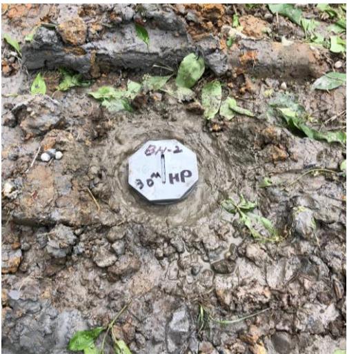
BH-2 施工後(埋設水壓計)
