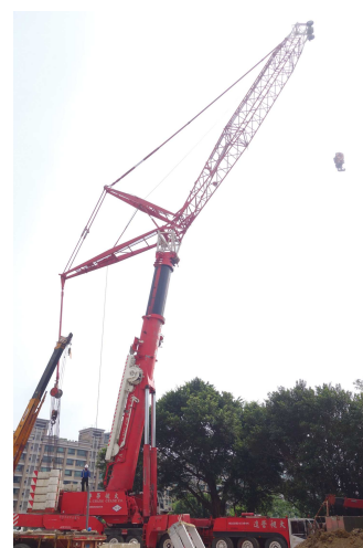
圖七-12 全吊車 (700 噸)
