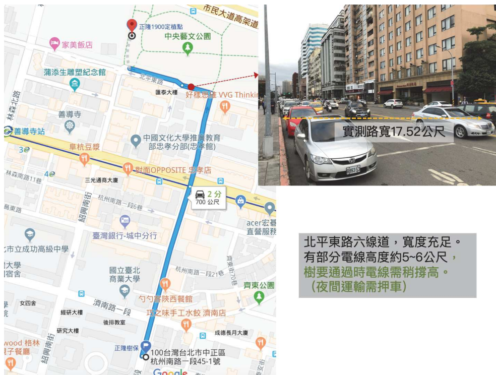
圖七-10 北平東路具六線道，部分電線高度為 5~6 公尺， 樹木運輸過程中需稍撐高，以利受保護樹木通過
