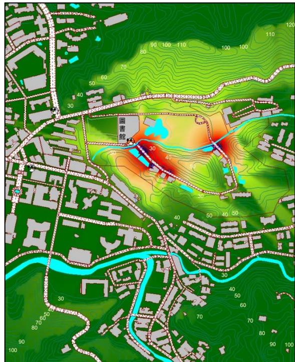
圖6.4.1-3 變更後宿舍區施工機具衍生營建噪音CadnaA模擬圖(Leq<sub>日</sub>)
