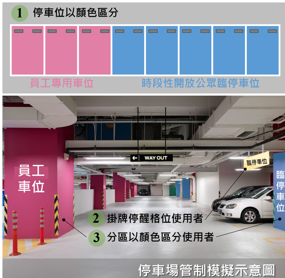
圖8-14 基地內部車輛管制模擬示意圖
