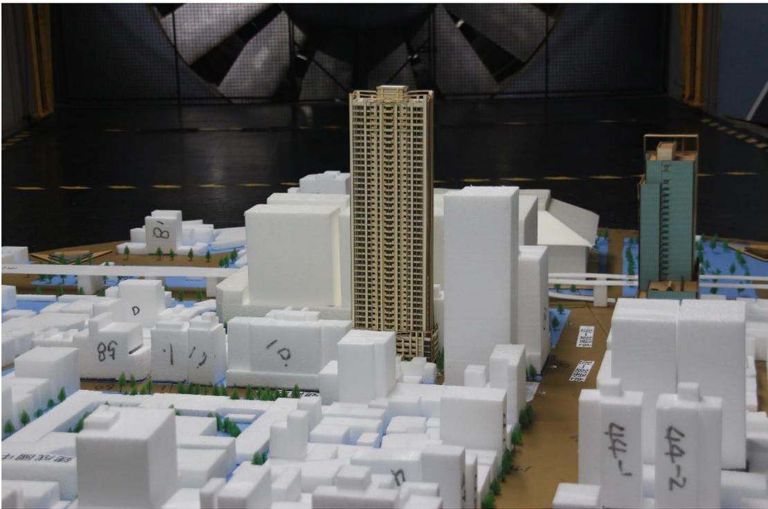
圖 7.1.5-1 風洞試驗主模型及周圍地形佈設情形
