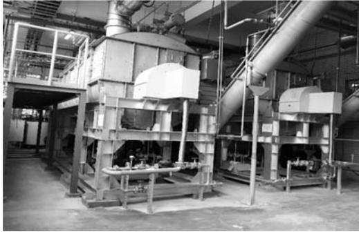
圖：污泥乾燥機房－污泥乾燥設備
