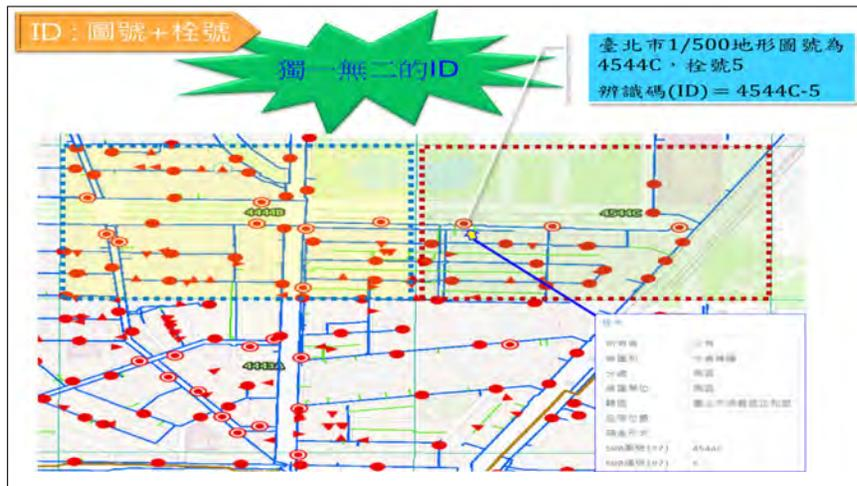
圖2-1 消防栓辨識碼(ID)說明(由北水處圖資系統展示圖號)
