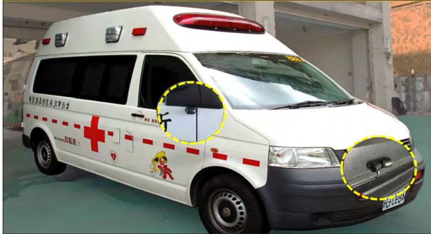
圖2-1 行車電眼輔助系統，廣角鏡頭安裝位置，於車頭最前端及車身兩側後照鏡下方
