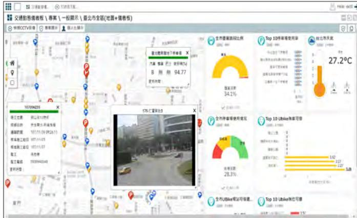
圖1-1 交通即時動態顯示參考畫面(現今動態展示系統以整合型資料展示方式為主流，將以Web GIS地圖為基礎，累加各種設備與設施之資訊，即時顯示於畫面中)
