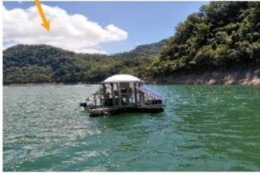
水質監測網(5處自動監測站構成)
