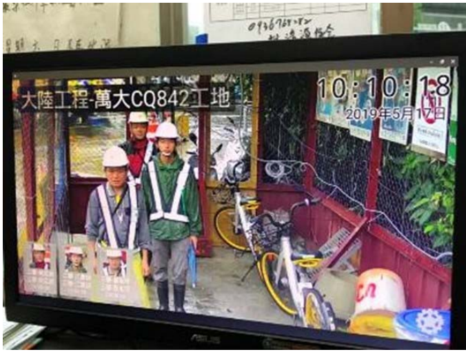
工地設置人臉辨識系統進行門禁管制、高壓變電站採取指紋辨識門禁管制。
