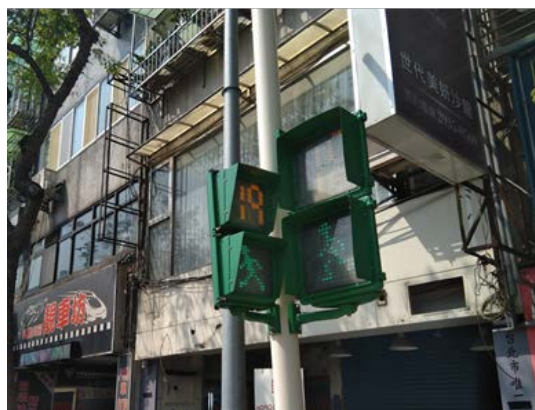
圖 3 30 公分放大型行人專用號誌（左方為現行 20 公分行人專用號誌）
