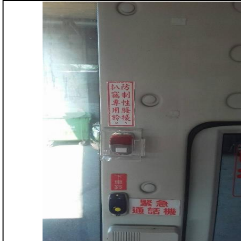
設置專用鈴，倘乘客遇有性騷擾事件，按下專用鈴發出警示音，以利駕駛長採取後續性騷擾防制作為。
