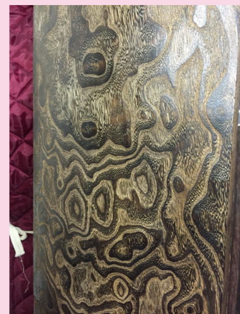
圖 3：表面經過快速炙燒炭化及鋼刷處理後的古箏面板，木紋上的節眼更加清晰，如同一幅渾然天成的水墨畫。日本光安慶太工廠（2015年，樊慰慈攝）
