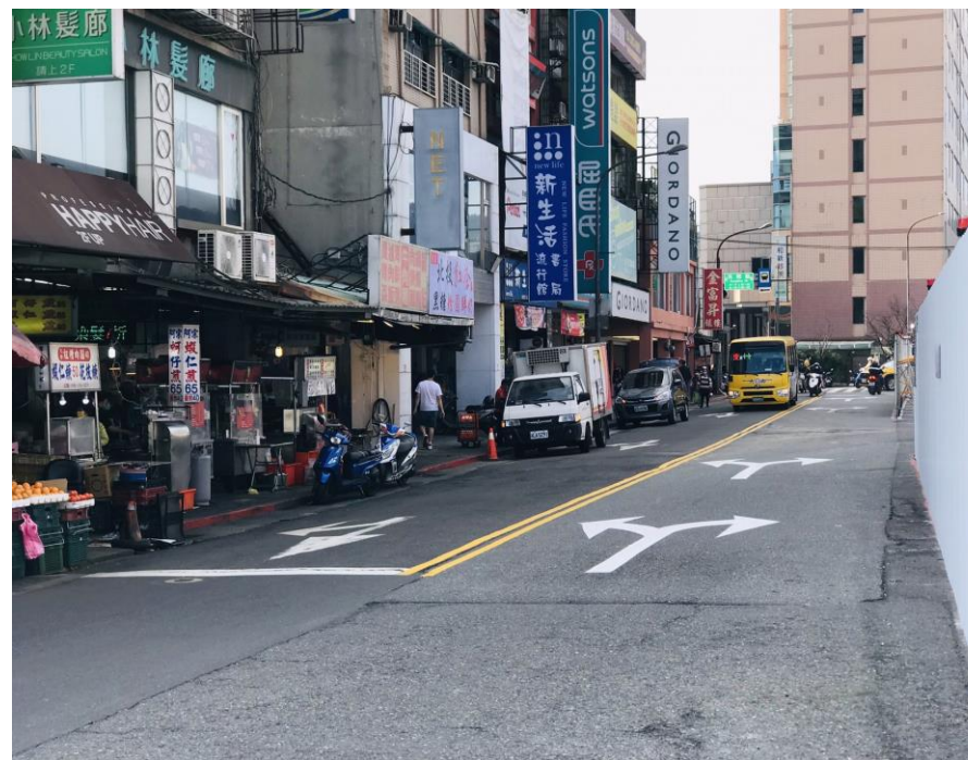
圖 5、【調整後】迴車彎及其號誌牌面取消
