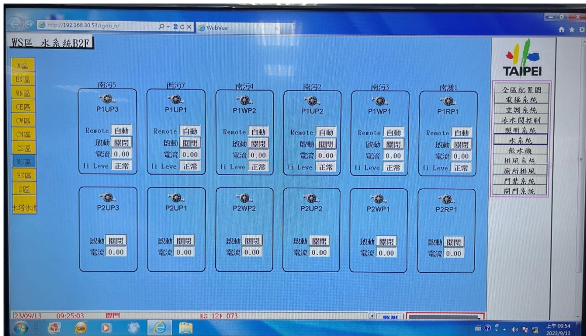
圖 2.19 給排水系統現況畫面
