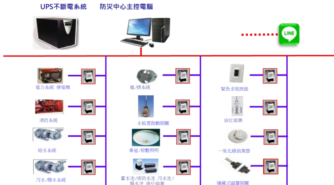
圖 2.2 智慧化系統整合管理平台架構示意圖
