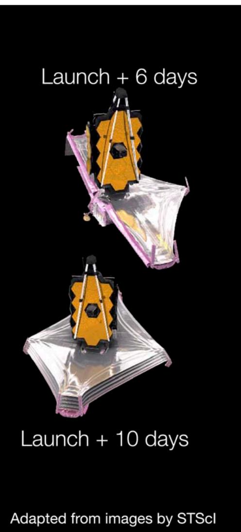
圖3：韋伯望遠鏡在太空中展開的過程。
