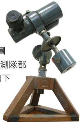
圖2. 武藤製造觀測人造衛星望遠鏡
