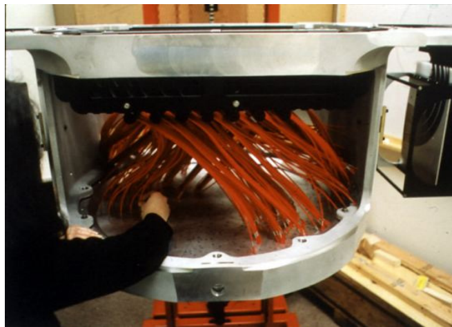
圖3. 觀測人員正在把光纖插入已經鑽好洞的鋁片，上面是光譜儀，待光纖安裝完畢，會將整個儀器倒置並安裝在望遠鏡焦平面的底部。圖片來源：SDSS
