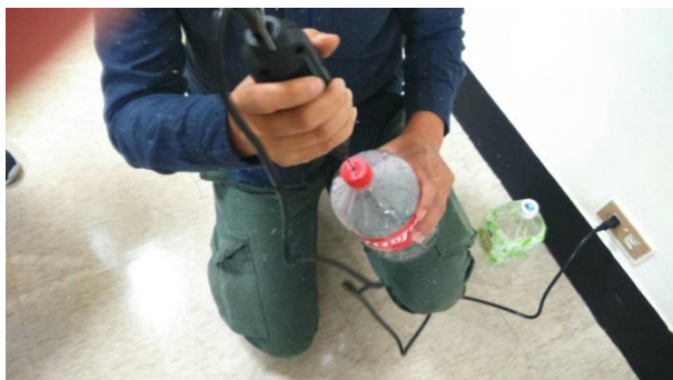
①於寶特瓶蓋子上方鑽洞，開口為棉線可穿入的大小即可。
