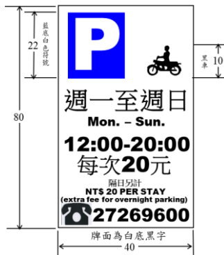
(路邊機車收費牌面範例)
