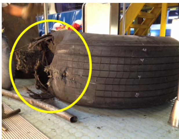
行走輪磨損破裂
