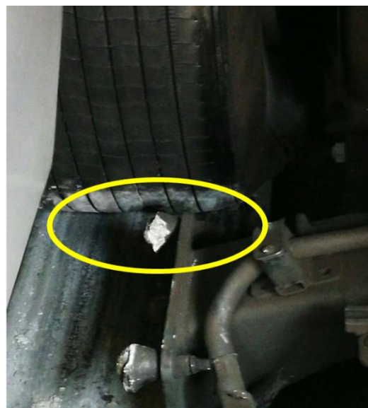
行走輪磨損破裂
