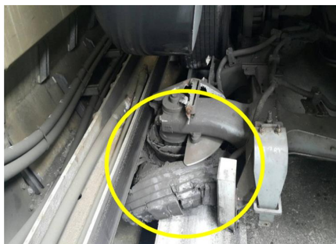
車身傾斜，導引輪破損
