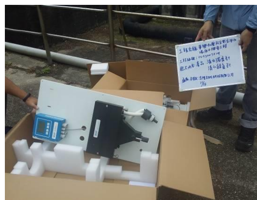
水質檢驗儀器(餘氯計及濁度計)進場點驗
