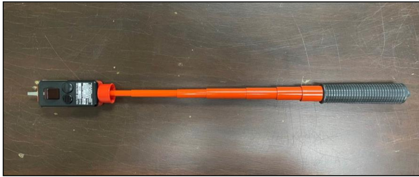
圖二十五、伸縮型高低壓檢電器 (檢驗範圍 80V~25000V，伸縮後可達 75 公分)
