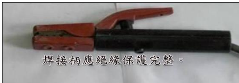
圖十二、電焊機焊接柄應具絕緣被覆
