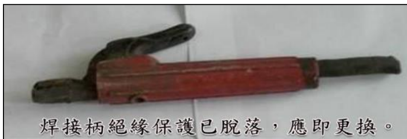
圖十三、電焊機焊接柄絕緣被覆不得破壞或損毀 法令依據：職業安全衛生設施規則第 245 條
