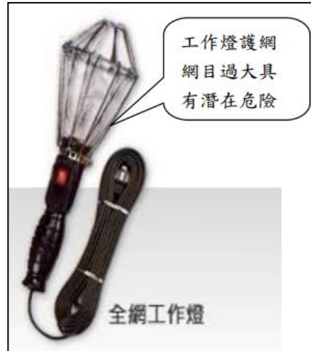
圖六、工作燈護網之網目過大具有潛在危險，曾發生人員手指觸及燈座帶電部分而發生感電災害。
