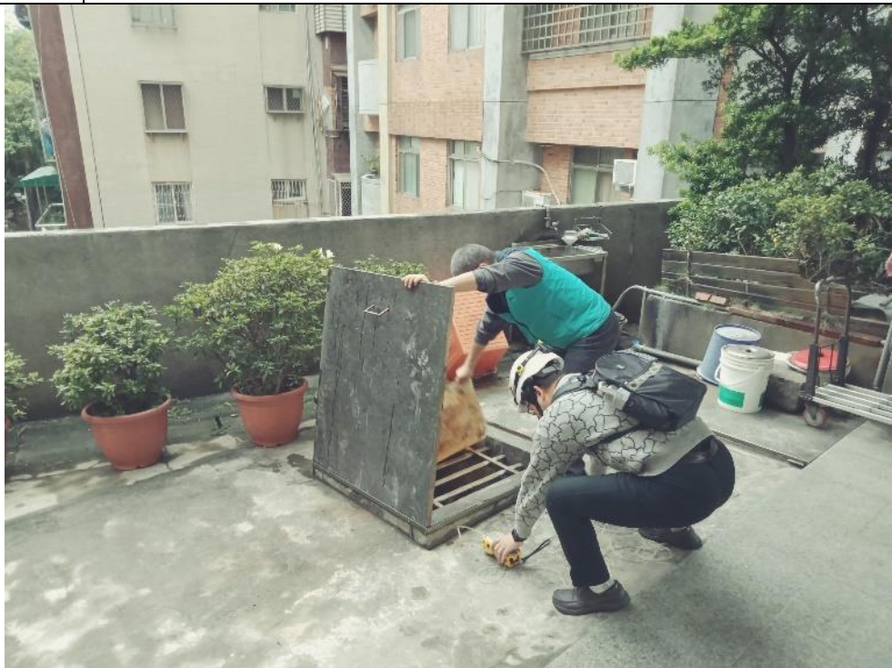
說明二 北市勞檢處量測水塔內硫化氫( H_2S )濃度為43.6ppm(勞工作業場所容許暴露濃度標準規定之硫化氫任一時間濃度不得超過10ppm)。
