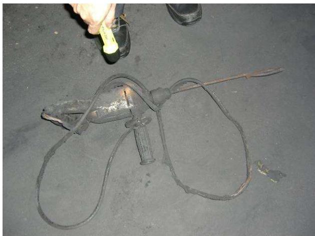
說明：員工使用手持式攪拌機作為攪拌混合機具，機具本身並非防爆型，啟動時所產生之電氣火花引起爆炸
