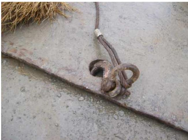
一端勾在鋼板外側圓孔的吊鉤，未有防止吊舉中所吊物體脫落之裝置。
