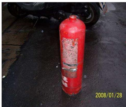
說明：罹災勞工從事滅火器受損彎曲插鞘更換作業現場及肇事滅火器空瓶之照片。
