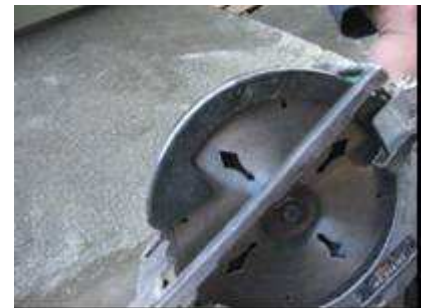
說明：功能正常之圓盤鋸可動式覆蓋自動回復至閉止點。
