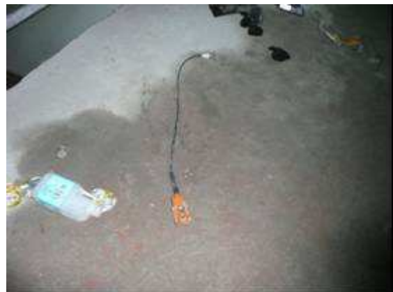
說明：掉落地面捲揚機控制開關。
