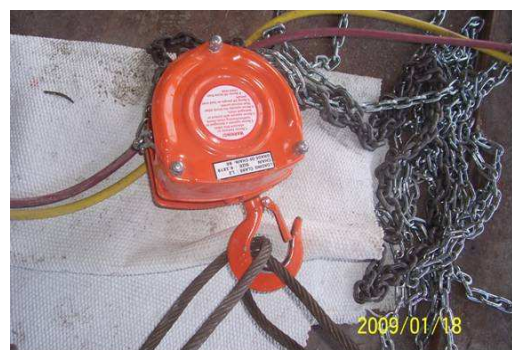
說明：墜落之吊掛鉤具。
