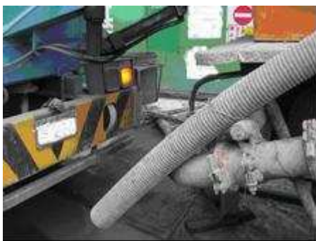
說明：壓送車與輸送管(模擬圖)。
