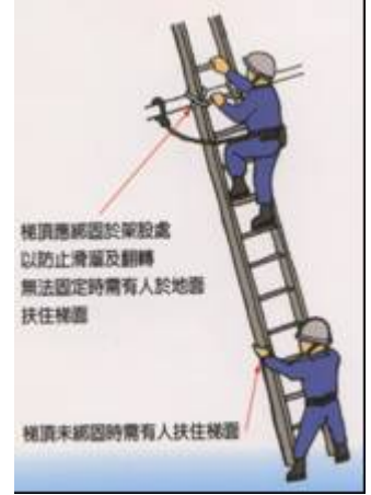
說明：使用移動梯正確作業方式。
