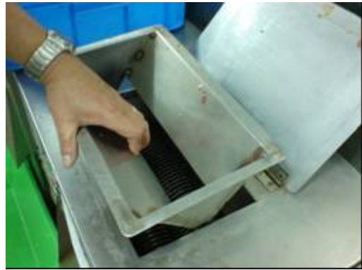
說明：對於機械之掃除、上油、檢查、修理或調整有導致危害勞工之虞者，應停止相關機械運轉及送料等再行作業。
