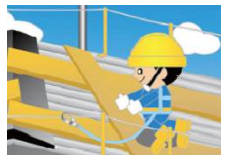
說明：屋頂作業應於屋架上設置適當強度，且寬度在 30 公分以上之踏板或裝設安全護網。
