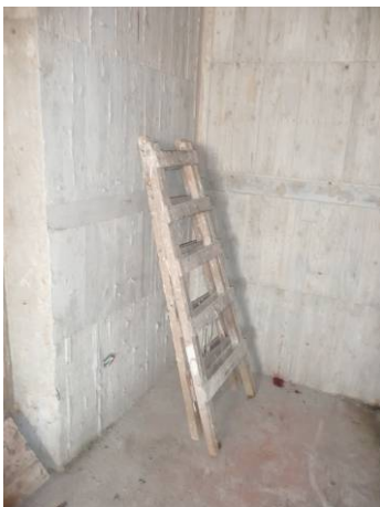
說明：現場作業使用之木合梯。
