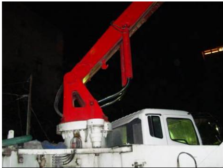
說明：油壓缸軸心扭曲變形。
