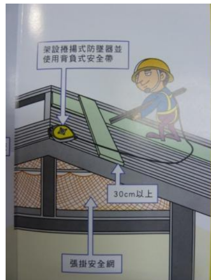
說明：屋頂相關作業防墜設備。
