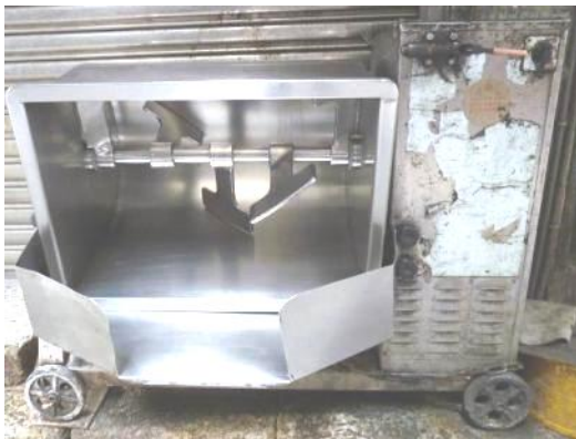
說明：林○○徒手伸入電源未關閉之攪拌機。
