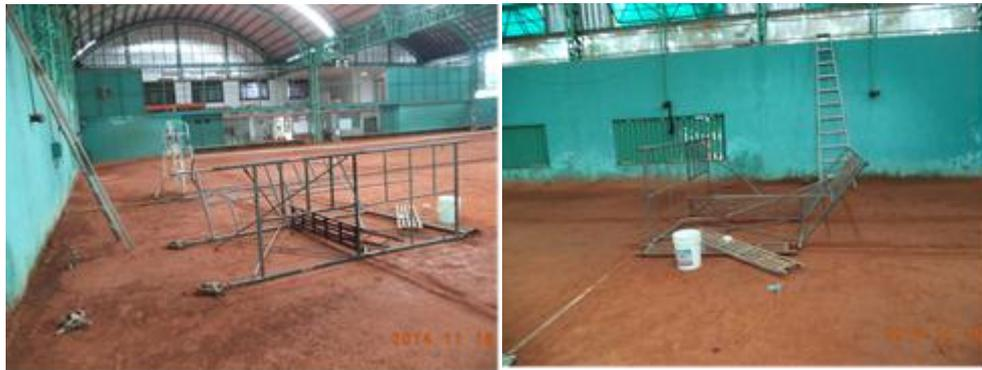
說明：施工架結構鬆脫
