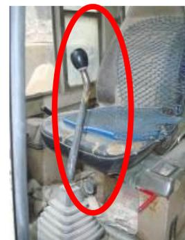
說明：夾具挖斗機械駕駛座內之機械轉盤操作桿。
