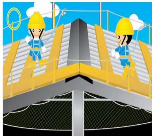
說明：於易踏穿材料構築之屋頂從事作業時，應於屋架上設置適當強度，且寬度在30公分以上之踏板，並於下方適當範圍設置防墜設施。
