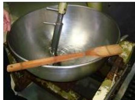
說明：使用手工具(攪拌棒)作輔助攪拌，避免人員將手伸入攪拌之麵糰中，亦可防止被捲危害發生。
