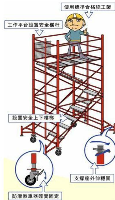
說明：應正確使用合格移動式施工架進作業。
