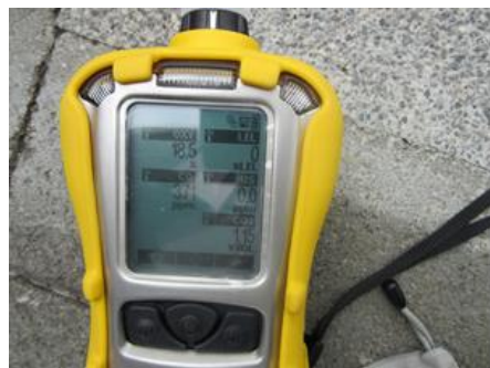
說明：事發2日後，作業現場一氧化碳濃度仍高達371ppm、二氧化碳濃度高達11500ppm。
