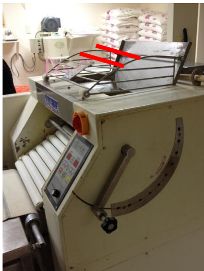
說明：肇災之壓麵機。 (應於危險之部分設置護圍，如紅線處)
