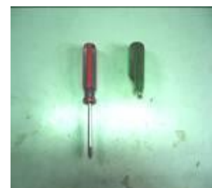
說明:罹災者遭斷裂螺絲起子飛散刺入左小腿位置模
