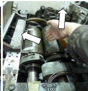
照片說明：模擬示意圖，勞工未使用適當工具，以手指調整機器，導致夾傷。
