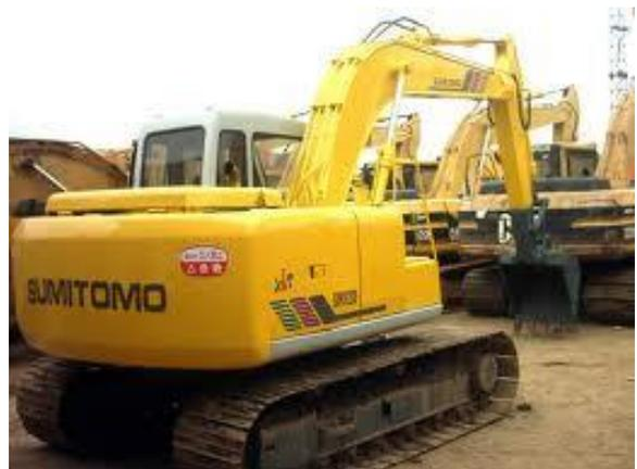
說明：車輛系營建機械之履帶不可充當上下設備，應嚴禁人員攀爬，以免滑落。
