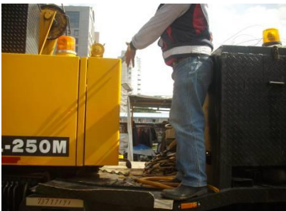
說明：受傷勞工於起重機車台收納捲揚鋼索位置處。
