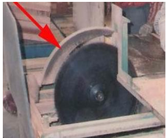
說明：木材加工用圓盤鋸應設置安全防護設備（覆蓋）。
