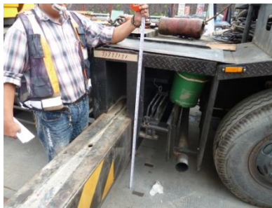
說明：受傷勞工遭起重機上部旋轉體之旋轉動作碰撞墜落災害示意圖。
