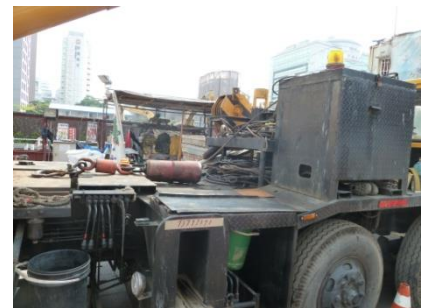
說明：受傷勞工墜落之起重機車台高度(約1.25公
