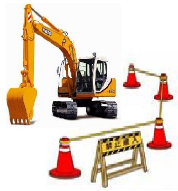
說明：嚴禁操作人員以外之勞工進入營建用機械之操作半徑範圍內。
