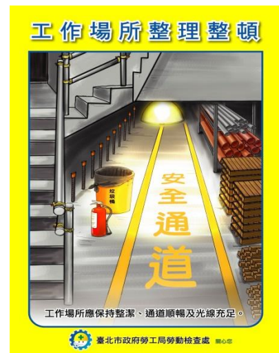
說明：雇主對於勞工工作場所 之通道、地板、階梯，應保持 不致使勞工跌倒、滑倒、踩傷 等之安全狀態，或採取必要之 預防措施。
