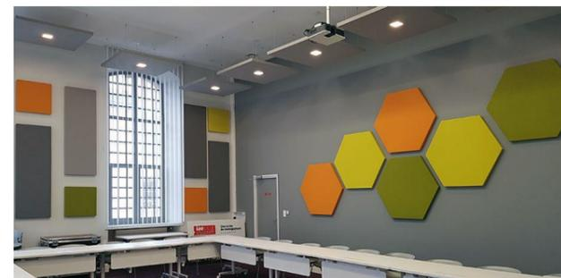
教室牆面: 隔音隔間牆+組合式裱布吸音牆+吸音壁布
