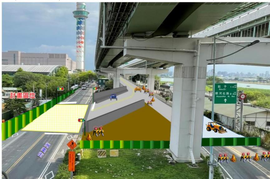
圖 2.8-4 第三階段施作洲美快速匝道下方排水箱涵示意圖
