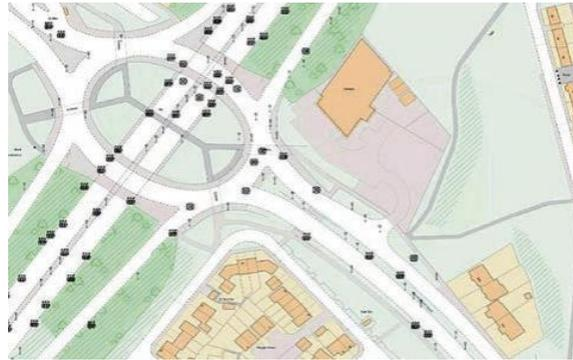
英國地形測量局 ( Ordnance Survey ) 有感於每年需投入大筆道路資產維護預算，發展出以人工智慧，輔以車輛感測載具和地理定位工具之萃取道路設施、公共資產之技術服務。目前能辨識出路上標誌、號誌、標線、路燈、郵筒、人孔蓋、變電箱、安全柱、排水孔等。
