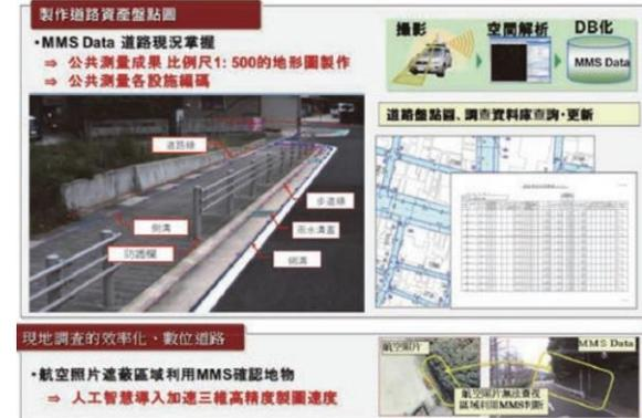
日本產製高精度3D地圖 ( 比例尺優於 1/500 ) 用於道路資產的盤點以及道路路側設施的都市規劃，例如都市市容與人行道無障礙設施規劃，設施巡檢與養護管理，而三維空間資訊於海嘯與淹水的模擬，進而用於防災避難規劃使用設備規劃，如右圖可見道路上的許多設施已編號並且記錄其空間位置與維修紀錄。
