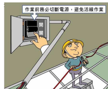
說明：勞工鄰近潮濕場所作業有接觸絕緣被覆配線而引致感電之虞者，應先關閉電源，避免活線作業。
