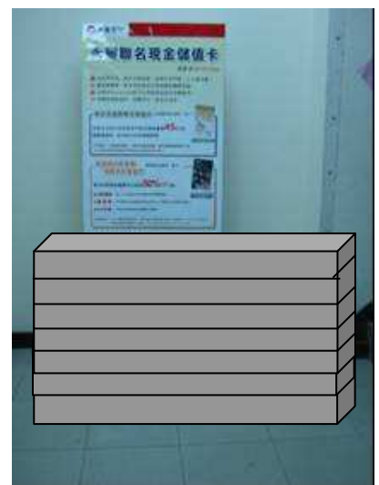
說明：板料應以水平方式堆積，以防止倒塌災害發生。
