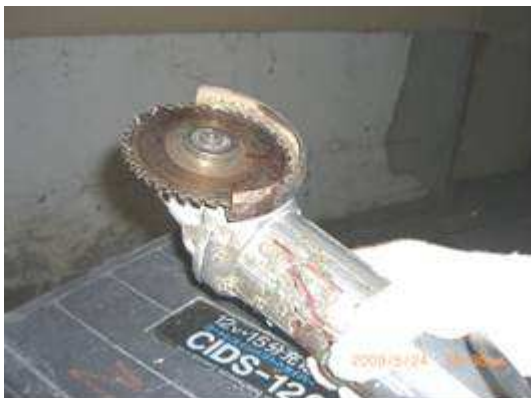
說明：罹災勞工手穿戴棉質手套使用切割器具，不慎割傷手指。
