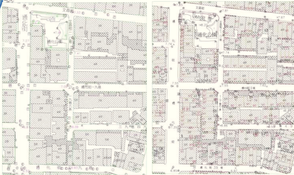
重製前 重製後 重製前後1/1000數值地形圖比較
