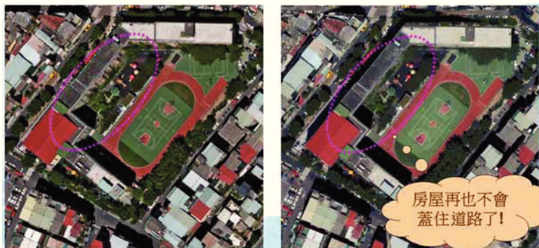
真實正射影像成果，圖左為一般正射影像，圖右為真實正射影像
