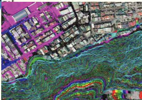
地面點點雲套疊正射影像及使用等高線編修實例
