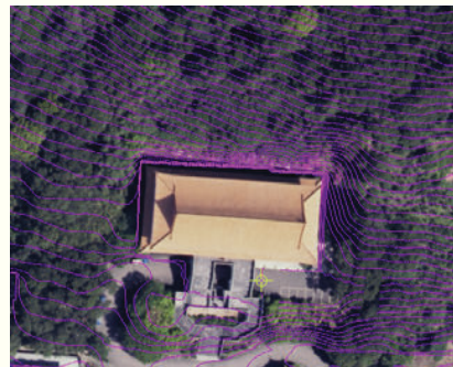
地面點點雲套疊正射影像及使用等高線編修實例
