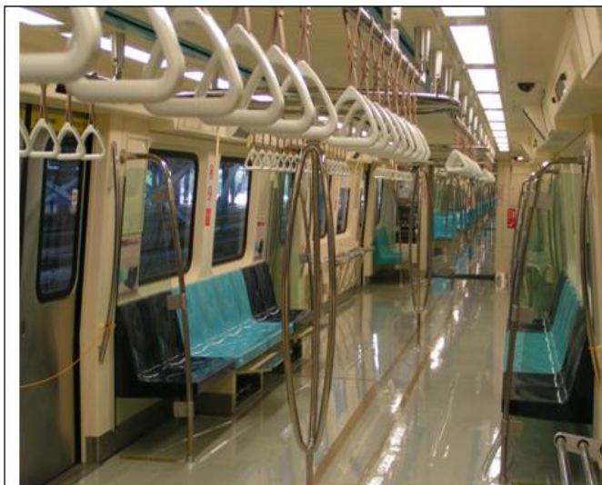
信義/松山線電聯車三叉式立柱
