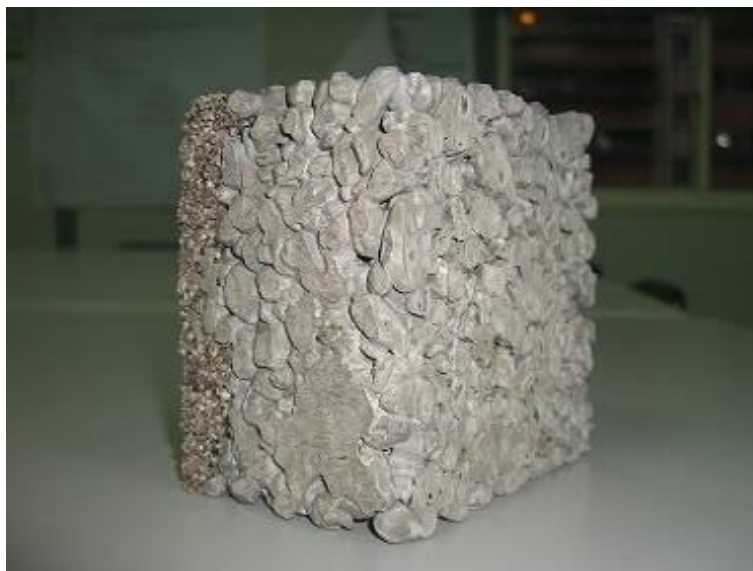
圖 2-3 透水混凝土試體
